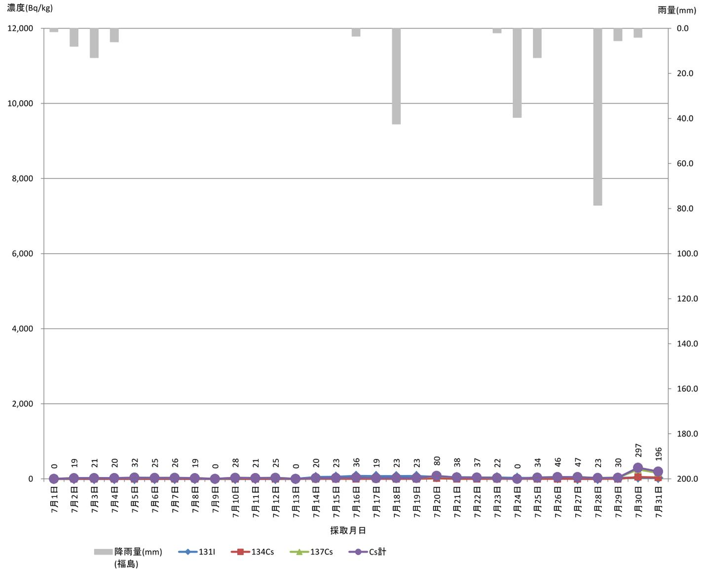
下水道終末処理場放射性物質濃度モニタリング結果（県北浄化センター） 脱水汚泥（H29. 8月）
