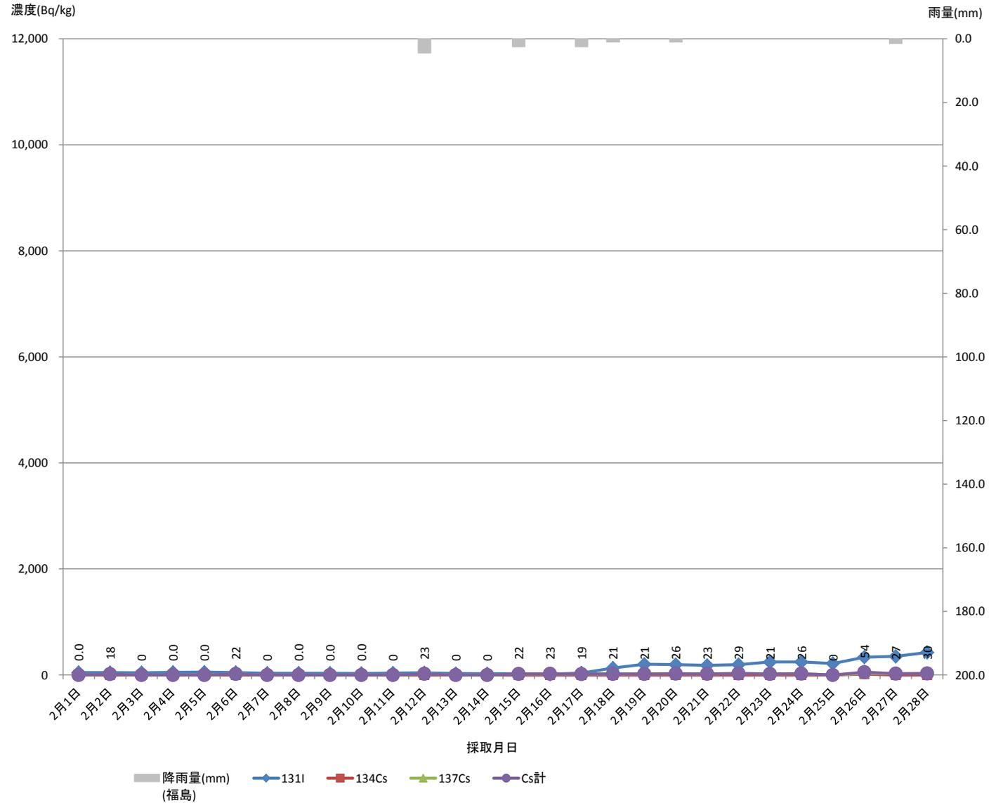
下水道終末処理場放射性物質濃度モニタリング結果（県北浄化センター） 脱水汚泥（H30. 3月）
