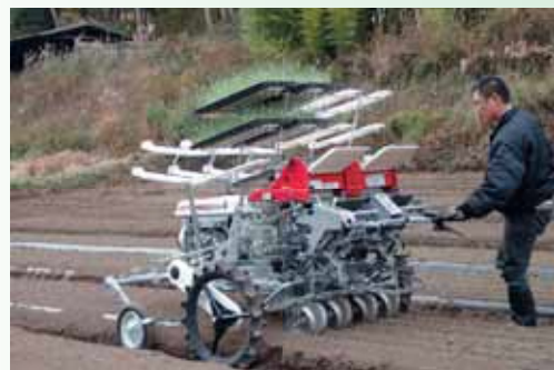
タマネギの機械による定植作業
