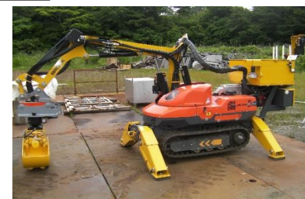
BROKK100D 主な役割 ・残置物(小物)の片付 ・フェンスの切断・片付 等
