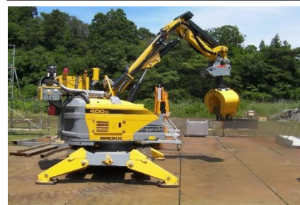
BROKK400D 主な役割 ・Warriorの移動 ・フェンスの切断・片付 等
