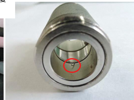
接続部内部のシールド線
