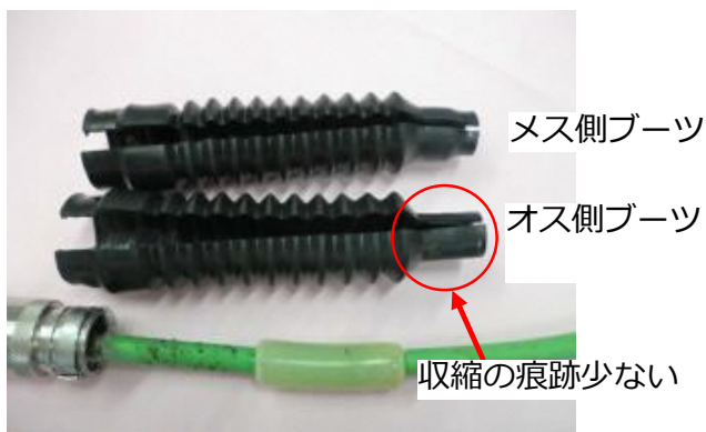
②ブーツの熱収縮状況
