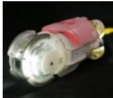
3号機調査装置
