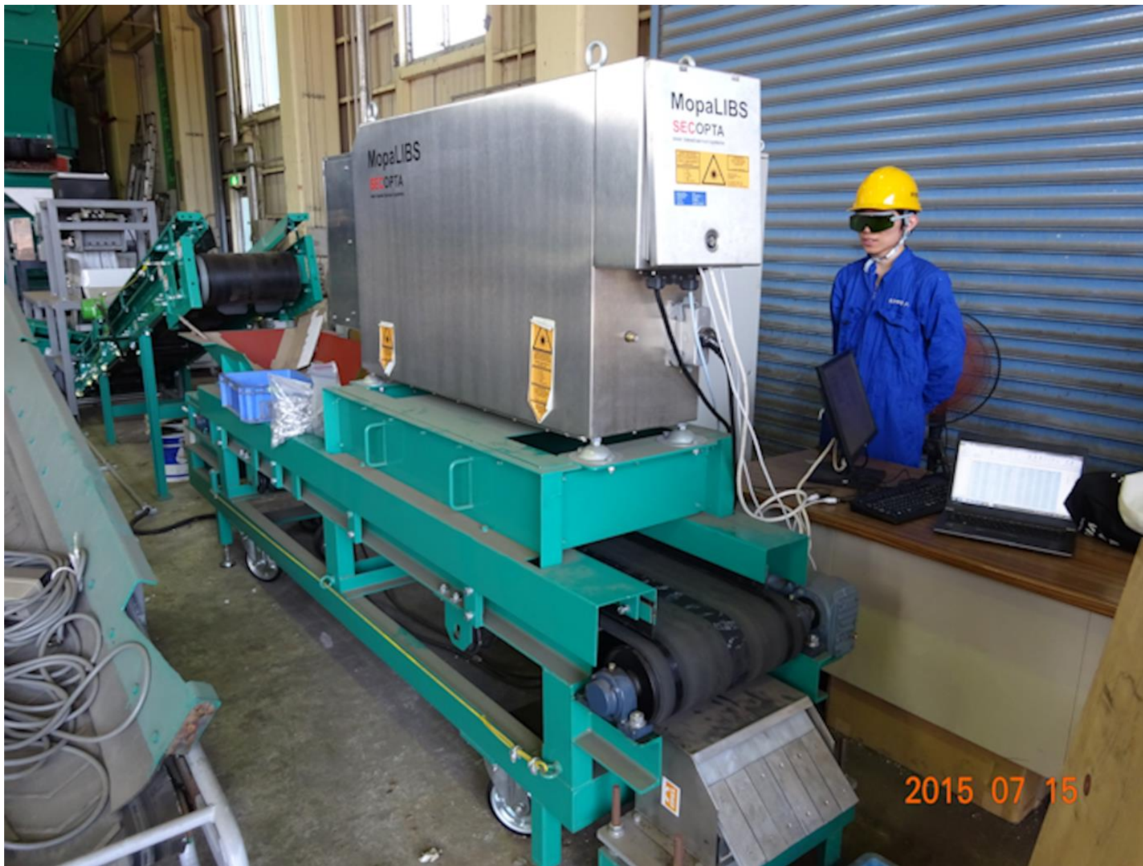
ハリタ金属に導入した世界初の産業用LIBSソータ, 1502
