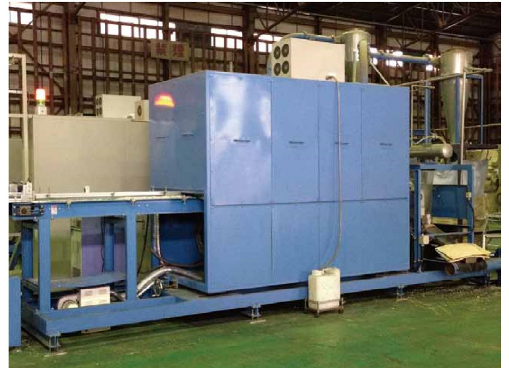
ラマン分光プラスチックソータ (モデルRPS-250-R50)
