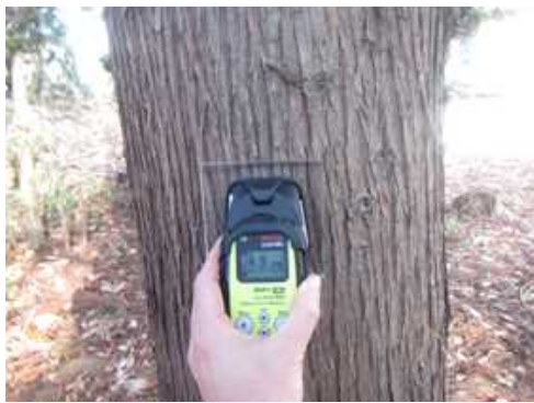
図-1 野外における GM 管式サーベーター(RadEye-B20)を用いた測定状況(左)とアクリル板(右)
