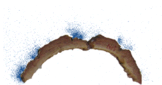
図-4 樹皮の放射性物質の2次元分布画像 (放射性物質分布(青)と樹皮写真の合成画像)
