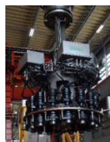
クレーンツール類 (構内輸送容器締め装置)
