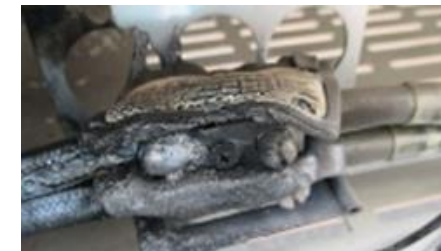
ブレーキレジスタ内の損傷（5月12日）
