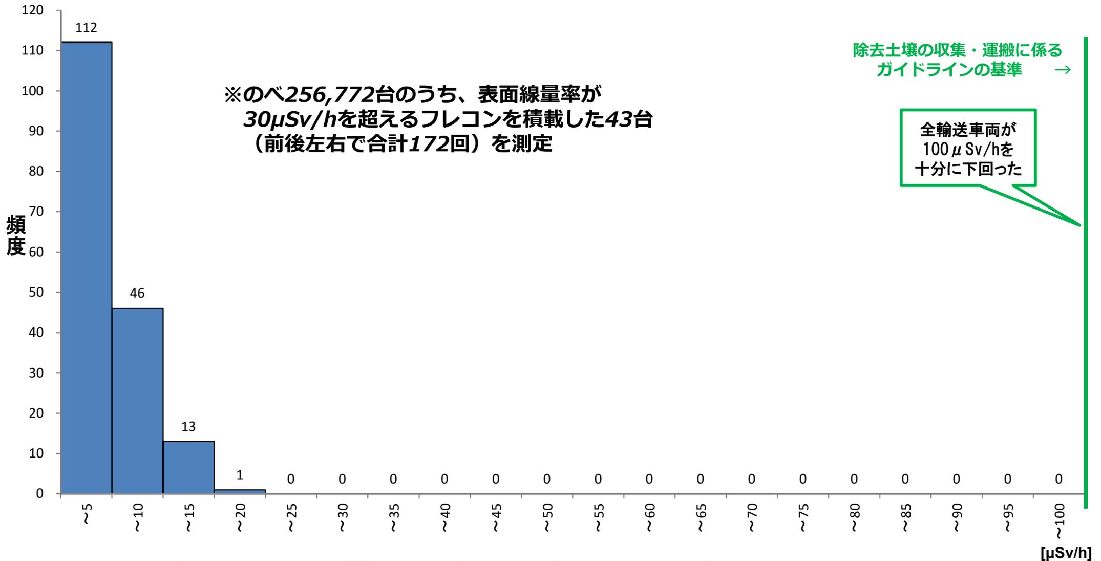
輸送車両周辺の空間線量率の測定結果(2018年4月1日~2019年3月17日) ※バックグラウンドの影響も含む
