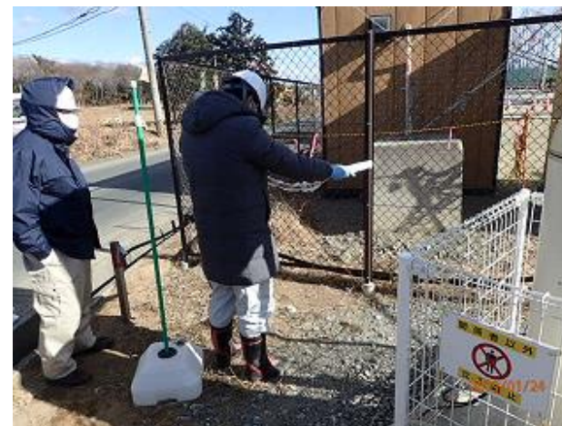
土壤貯蔵施設における空間線量率の測定
