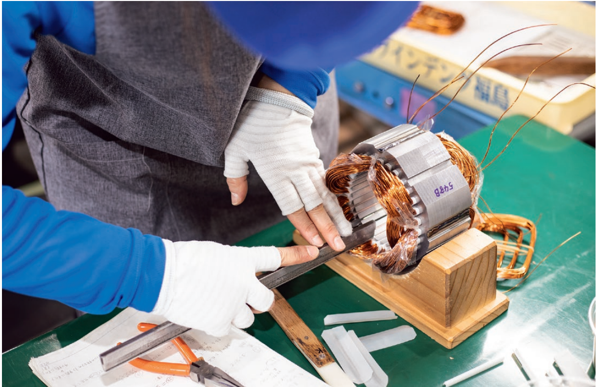
小型インダクションモータのステータ製作
