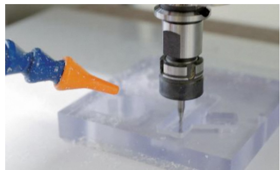
切削RPマシンは、3D CADデータをフル活用し、外觀デザインやパーツ試作、生産治具製作、小ロット生産まで幅広く活躍し、最適な切削加工を実現します
