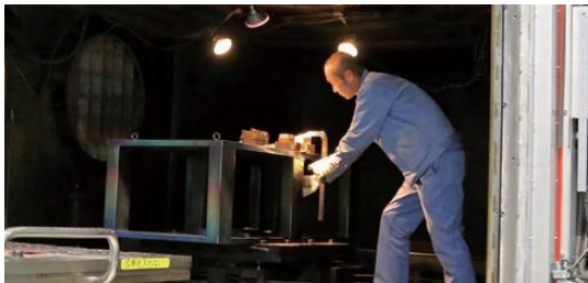
電子ビーム溶接による異種金属溶接作業
