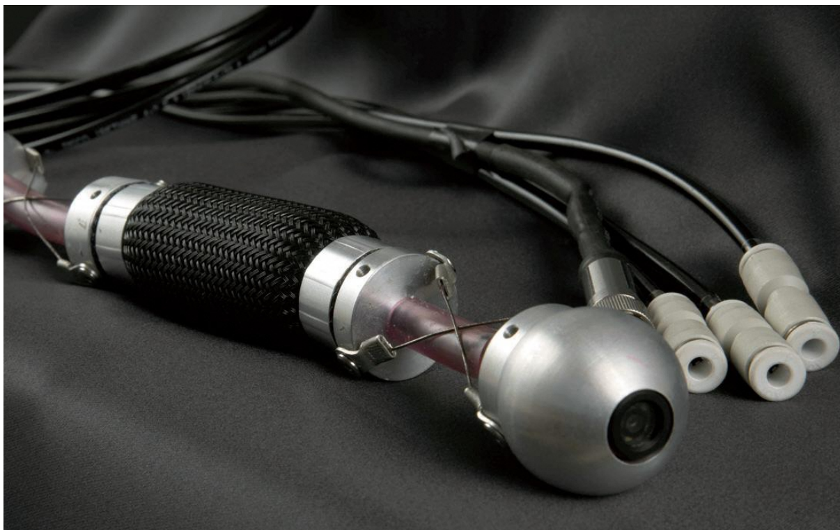
人工筋肉を活用した配管調査用ロボット
