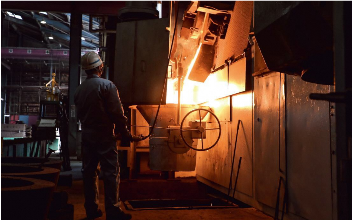
失敗が許されない鋳込み、品質を左右する大事な行程。1点から鋳型の製作も可能
