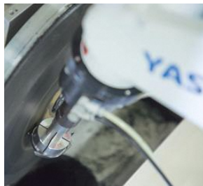
ロボット研磨により研磨工程を自動化
