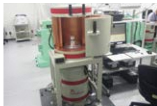
ゲルマニウム半導体検出器 (ガンマ核種の測定)
