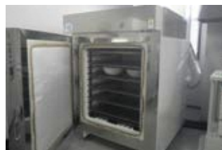
灰化炉(固体試料を灰化濃縮)
