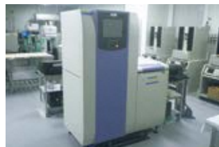
液体シンチレーションカウンタ (トリチウムの測定)
