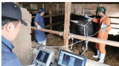
超音波肉質診断装置による画像取得の様子
