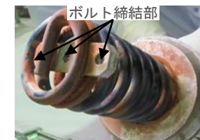
分離したがれき撤去ツール（熊手）の下部
