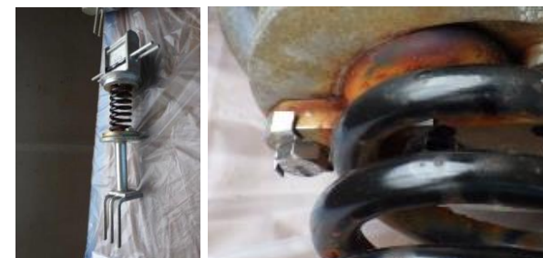
熊手緩み対策実施後
