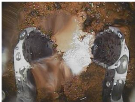
図 2号機の堆積物接触調査※
