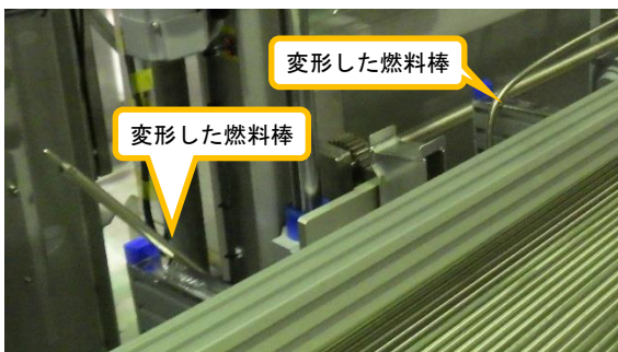
(写真2) 変形した燃料棒
