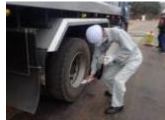
保管場退出車両の 線量率測定
