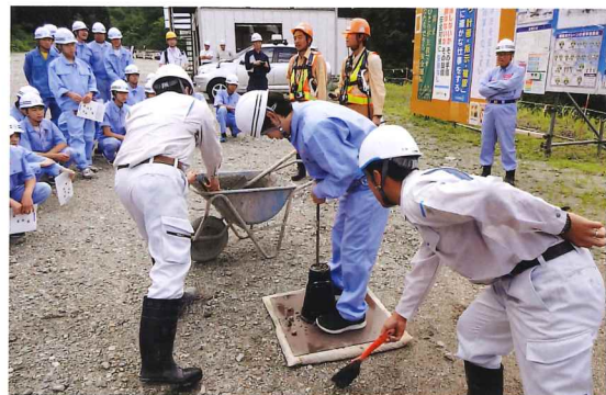
コンクリートのスランプ試験に挑戦です、設計値に入るかな。
