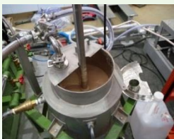
木材からのメタン発酵実証プラント
