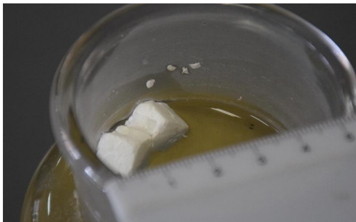
写真7 検証実験2により生じたMP
