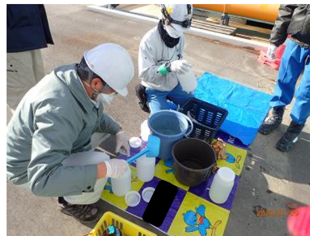
土壌貯蔵施設放流水の測定
