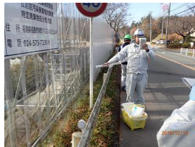
固型化処理施設における空間線量率の測定
