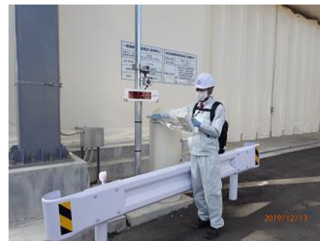
第二保管施設における空間線量率の測定
