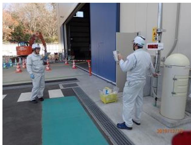
固型化処理施設における空間線量率の測定
