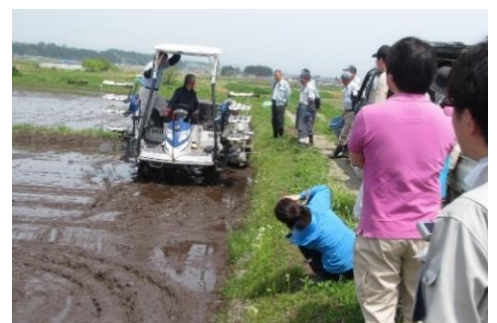
可変施肥直播機による播種作業
