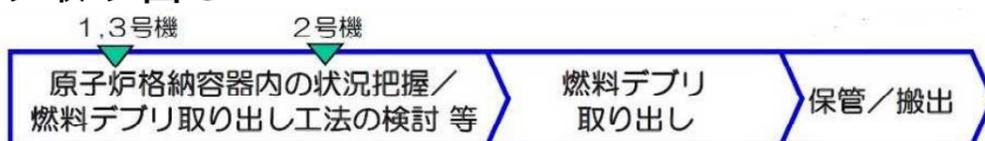
デブリ取り出しの初号機は、昨年2月に実施した格納容器下部の燃料デブリへの接触調査による性状把握や原子炉格納容器へアクセスするための原子炉建屋内の環境整備状況などを考慮し、2号機が妥当と評価された。取り出し工法としては、ロボットアームを活用し、試験的な取り出しに着手した後、取り出し方法の検証や確認を行った上で、段階的に取り出しの規模を拡大していく。
