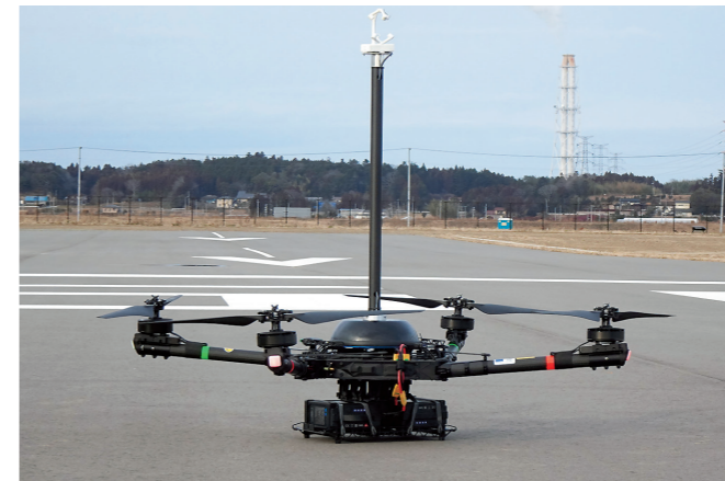
気象観測装置を搭載したドローン
