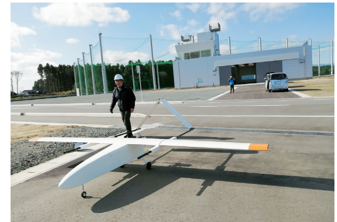
オリジナル長距離無人航空試作機（翼長 4m）
