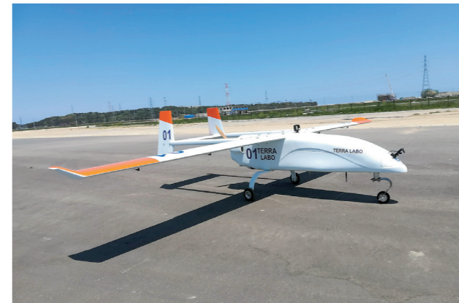
開発用固定翼無人機（翼長 4m）
