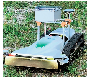
①みちびき受信ユニットを搭載したササキコーポレーションの草刈り機、スマモ
