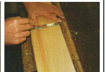
鉛筆を使ったけがき作業
