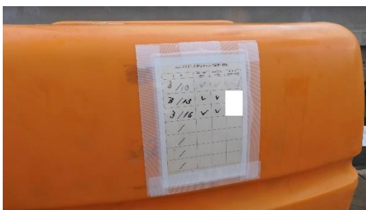
(写真2-2) 記録用紙を拡大。作業開始前後に締付けの有無をチェックするようになっている。
