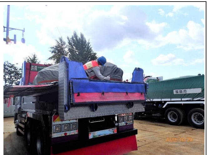
シートによる飛散・流出防止対策
