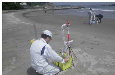
〈水浴場の空間線量測定の様子〉
