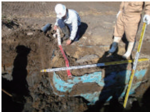
写真-1 宅地跡残留物(浄化槽)
