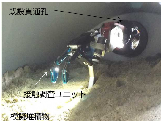
接触調査ユニットモックアップ状況
