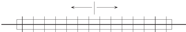
図 1 - 1 ボルト締付け順序
