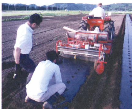
シーダーマルチャーによるマルチ・播種作業
