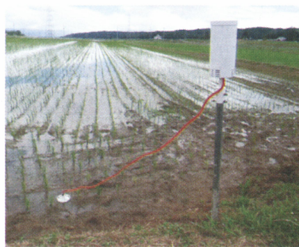
水田センサーによる水管理
