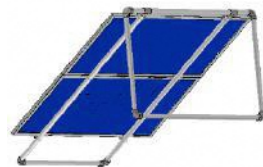
単管パイプ架台
