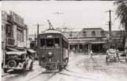
国鉄福島駅前を走る、保原行のチンチン電車（昭和11年）。当時はボールによる電力供給で走行しました。
