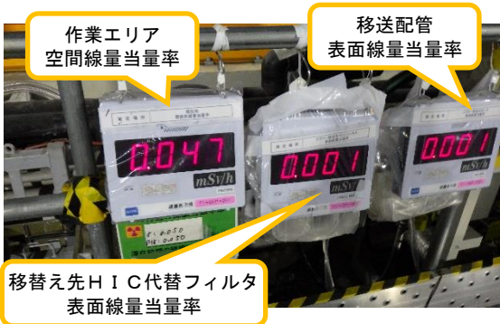
(写真 3) 連続測定している線量当量率の表示 状況 (南側から撮影)
