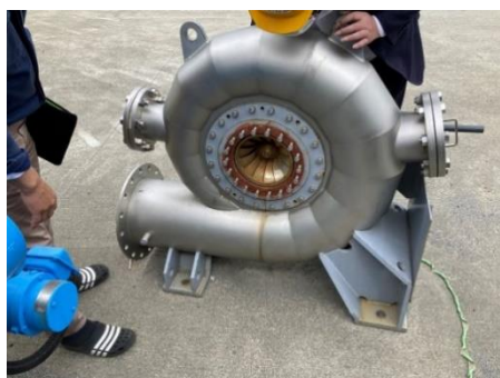
1533 1534 1535 1536 1537 1538 県内企業による小水力発電用水車の製造（提供：朝日機工㈱） 1539
