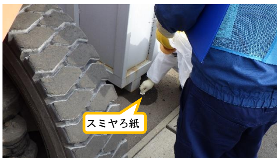
(写真2-1) 汚染状況確認の状況 (南西側から撮影)
