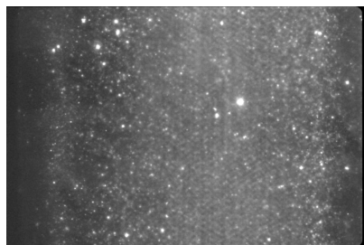
図-3 放射性物質捕捉装置の I P 画像 図-4 捕捉装置 I P 画像の角度別の濃淡度 （白黒反転，感光した箇所は白色）
