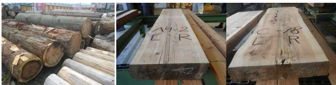
図-1 会津産大径スギ材 図-2 芯持ちの盤に加工 図-3 トビ腐れ材
