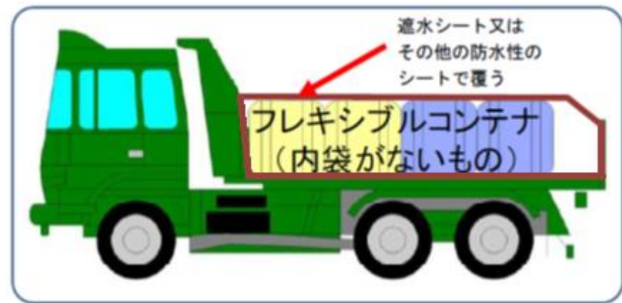
フレキシブルコンテナと遮水シートを組み合わせた運搬（例）
