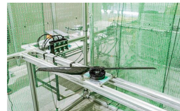
ドローン用モーター耐久試験風景
