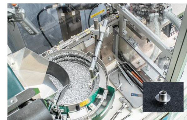
小型加工品自動外観検査装置
