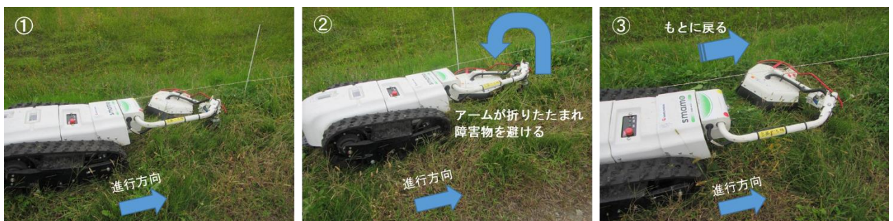
図1 自走リモコン草刈機による草刈状況
