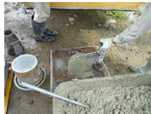
スランプ試験の状況
