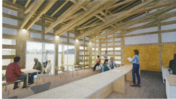
△執務室ローカウンターと木の格子状の耐震壁のイメージ
