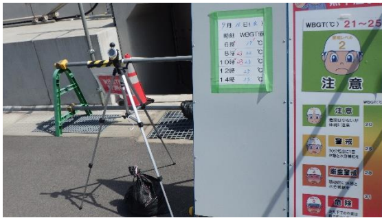
(写真7-1) 4号機タービン建屋東側に設置されているWBGT計及びWBGTの目安を示すパネル
