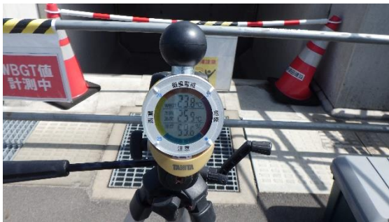
(写真7-2) 4号機タービン建屋東側に設置されているWBGT計
