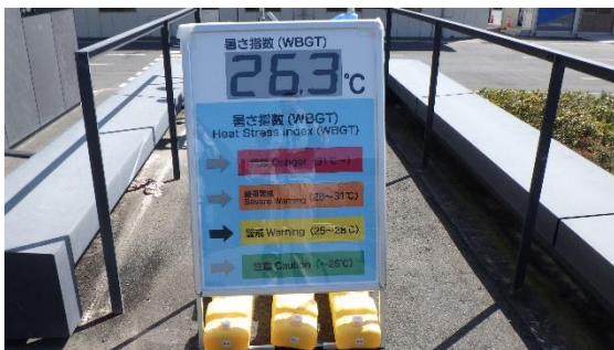
(写真1) 新事務本館南側に設置されているWBGT計及びその結果を表示するためのパネルの状況
