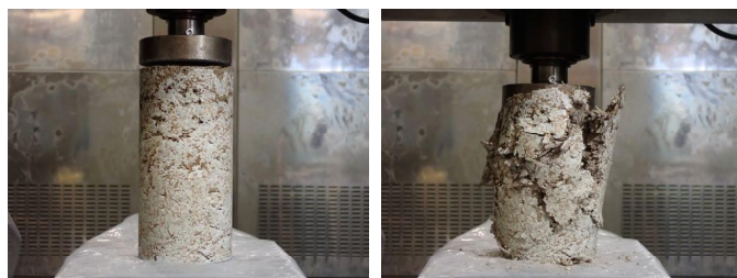
図-2 圧縮試験 (バーク 3 : セメント 7 (セメント 1 : 水 1) 試験体)
