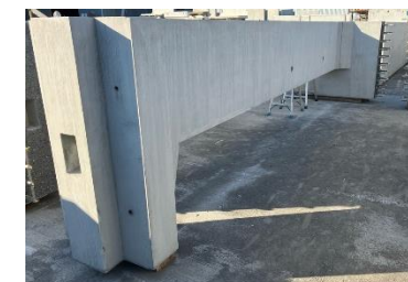
上流水槽隔壁
